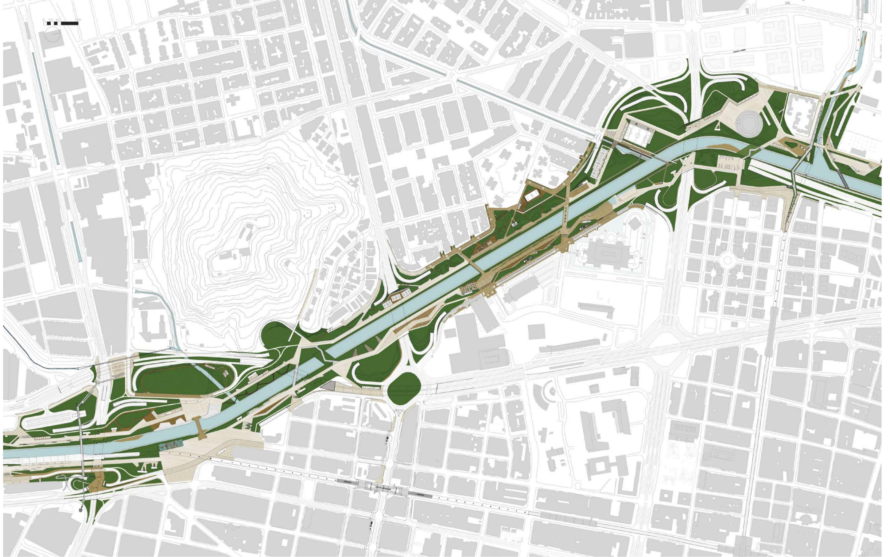
Tramo 3. Entre la estación Industriales y Avenida Colombia. Se destaca el soterramiento en las dos bandas del río, puentes peatonales y conexión importante con el cerro Nutibara.
